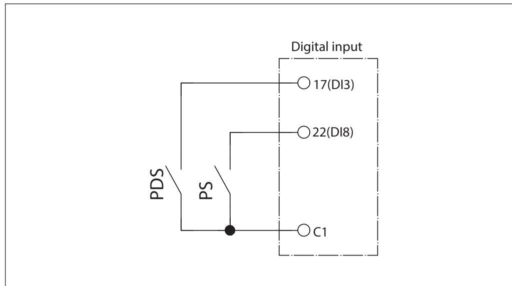
**Схема подключения KPI35R или PDS/ на дискретные выходы, потенциальный контакт**
